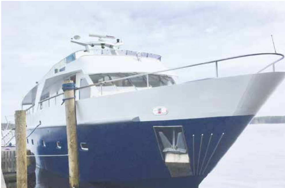
M/s Serena on 20 metriä pitkä, 5,85 meytia leveä ja sen syväys on puolitoista metriä.
